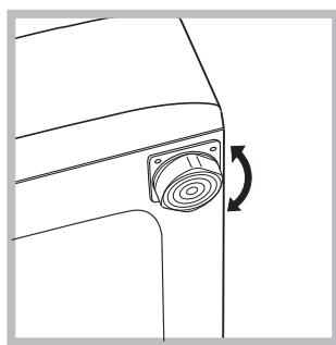
2. Dacă podeaua nu este perfect orizontală, compensați neregularitățile deșurubând sau însurubând piciorușele anterioare (a se vedea figura); unghiul de înclinare, măsurat pe planul de lucru, nu trebuie să depășească 2°.
