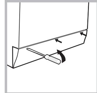
2. verifique que el nivel de agua en el interior de la máquina sea inferior al hueco de la puerta; si no es así, extraiga el agua en exceso utilizando el tubo de descarga y recogiéndola en un balde como se indica en la figura.
