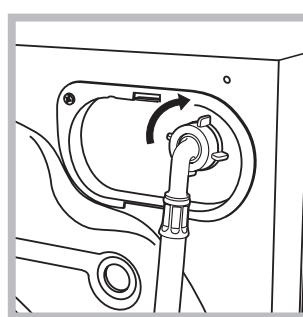
2. Conectați tubul de alimentare la mașina de spălat, însurubându-l la sursa de apă respectivă, amplasată în partea posterioară, sus în dreapta (a se vedea figura).
