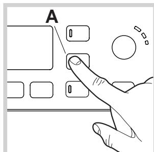
Das Programm wird durch 5-Sekunden-langes Drücken der Taste **A** (siehe Abbildung) gestartet (siehe abb.). Das Programm startet automatisch und dauert etwa 70 Minuten. Um den Zyklus anzuhalten, drücken Sie die Taste START/PAUSE.
