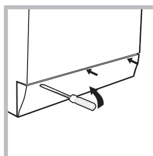
1. Nehmen Sie die Abdeckung (befindlich an der Gerätetürfront) mit Hilfe eines Schraubenziehers ab (siehe Abbildung);
