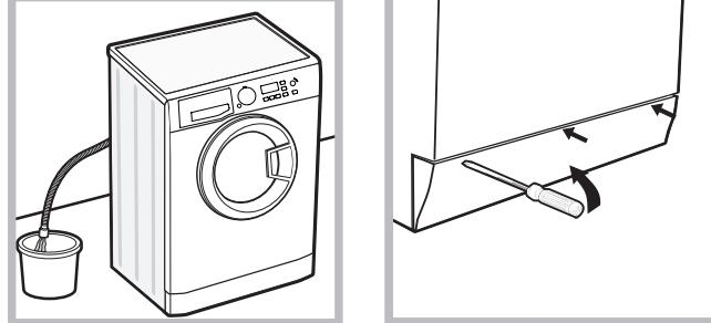
2. проверьте, чтобы уровень воды в машине был ниже отверстия люка. В противном случае слейте излишек воды через сливную трубу в ведро, как показано на схеме.
