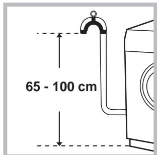
Conecte el tubo de desagüe, sin plegarlo, a un conducto de desagüe o a una desagüe de pared ubicados a una distancia del piso comprendida entre 65 y 100 cm.;
