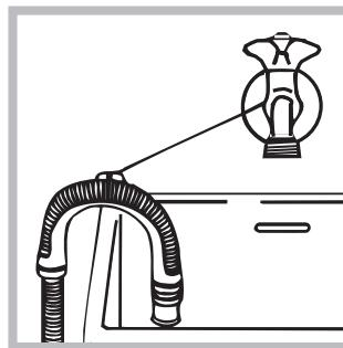
ou coloque na beira de um lavabo ou de uma banheira, prenda na torneira a guia fornecida (veja a figura). A ponta solta do tubo de descarga não deve permanecer emergida na água.
