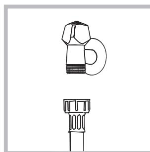
1. Schrauben Sie den Wasserschlauch an einen Kaltwasserhahn mit ¾-Zoll-Gewindeanschluss an (siehe Abbildung). Lassen Sie das Wasser vor dem Anschluss so lange auslaufen, bis klares Wasser austritt.
