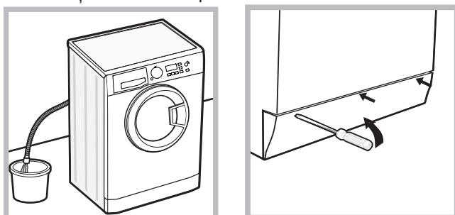
2. verificați ca nivelul de apă din mașină să fie sub marginea ușii; în caz contrar, scoateți apă în exces cu ajutorul furtunului de golire, punând-o într-un vas, după indicațiile din figura.
