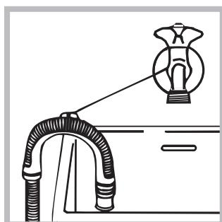
Sprijiniți-l de marginea căzii sau chiuvetei și racordați șina de ghidare din dotare la robinet (a se vedea figura). Capătul liber al furtunului de golire nu trebuie să rămână cufundat în apă.
