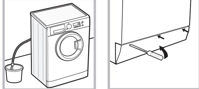
2. Stellen Sie sicher, dass der Wasserstand im Innern des Gerätes die Gerätetür nicht übersteigt, andernfalls lassen Sie das überschüssige Wasser, so wie auf der Abbildung veranschaulicht, durch den Ablaufschlauch in einen Eimer ablaufen.
