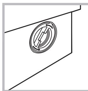
2. desenrosque a tampa girando-a no sentido anti-horário (veja a figura). É normal que perca um pouco de água;
