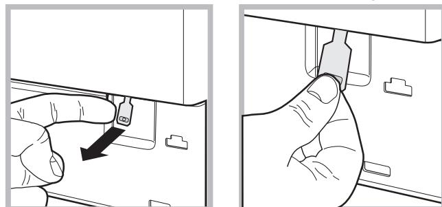
4. Befreien Sie mithilfe der auf der Abbildung veranschaulichten Zunge (nach vorne ziehen) die Kunststoff-Spannvorrichtung aus der Arretierung; ziehen Sie letztere dann nach unten und öffnen Sie gleichzeitig die Gerätetür.
