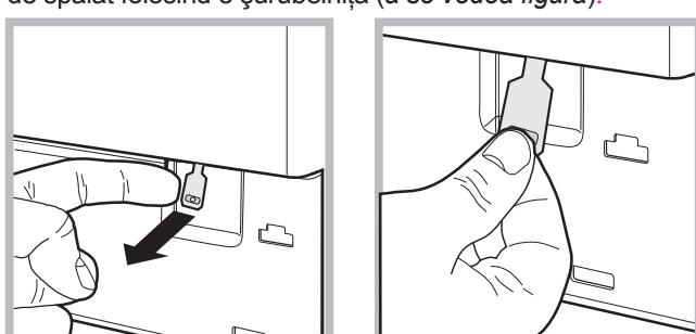
4. utilizând dispozitivul indicat în figură, trageți spre dumneavoastră până când eliberați tirantul de plastic din opritor; trageți apoi în jos și, în același timp, deschideți ușa.
