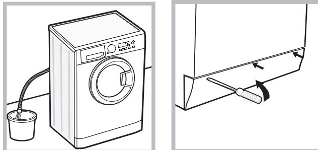
2. verifique que o nível de água no interior da máquina seja inferior respeito à abertura da porta de vidro; caso contrário, tirar a água em excesso através do tubo de descarga recolhendo-a num balde como indicado na figura.
