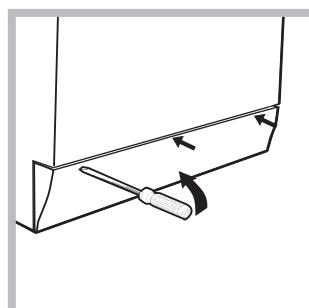
1. quite el panel que cubre la parte delantera de la lavasecadora con la ayuda de un destornillador (*ver la figura*);
