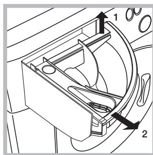
Para tirar a gaveta, erga-a e puxe-a para fora (veja a figura). Lave-a com água corrente; esta limpeza deve ser efectuada frequentemente.
