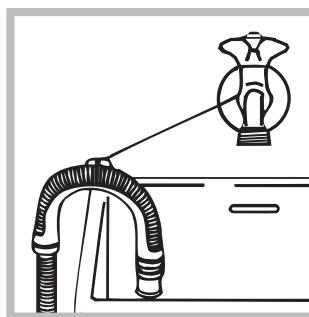
oder hängen Sie diesen in ein Becken oder eine Wanne ein; befestigen Sie den Schlauch in diesem Falle mittels der mitgelieferten Führung an dem Wasserhahn (siehe Abbildung). Das freie Ablaufschlauchende darf nicht unter Wasser bleiben.
