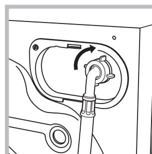
2. Conecte el tubo de alimentación a la lavaseadora enroscándolo en la toma de agua correspondiente ubicada en la parte posterior derecha (arriba) (ver la figura).
