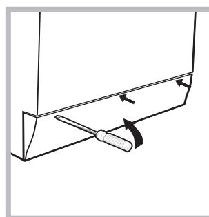
1. remova o painel de cobertura no lado anterior da máquina empurrando para o centro, em seguida empurre para baixo de ambos os lados e remova-o (veja as figuras).
