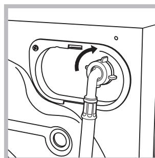
2. Das andere Ende des Schlauches an den oben rechts am Rückteil des Waschtrockners befindlichen Wasseranschluss anschließen (siehe Abbildung).
